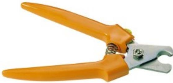
Schneidwerkzeuge/Kabelscheren für flexible Leiter mit einem Außendurchmesser bis 11 mm. Die halbkreisförmigen Schneiden verhindern ein Quetschen des Kabels
