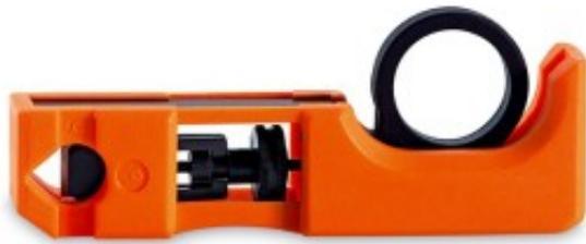
Werkzeug zum Abmanteln/Abisolieren von Kabel/Leitungen, einstellbare Schneidtiefe, v.a. für Datenkabel, Anritzen Stahlwellenmantels von Glasfaserleitungen
