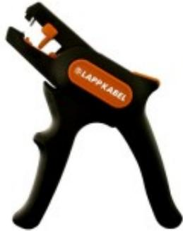
Ermöglicht einfaches, schnelles und gleichmäßiges Abisolieren flexibler und massiver Leiter; Einfache Handhabung, da automatische Selbsteinstellung auf den jeweiligen Crimpquerschnitt erfolgt; Ergonomische Kunststoffhandgriffe; Verstellbarer Längenanschlag von 5-12 mm; Auswechselbarer Messerkopf
