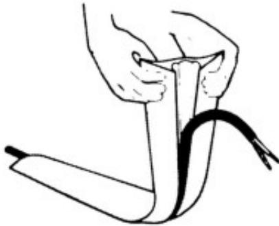
Die Lapp Gruppe bietet den STY Kabeltunnel aus Kunststoff an. Der Tunnel dient zur Abdeckung von Leitungen am Boden und als Tritt- und Stolperschutz.
