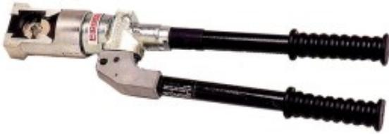
V 1311: Hydraulische Presszange/profi-Werkzeug für Rohr-Kabelschuhe und Stossverbinder, 10-400 mm<sup>2</sup>, Crimpprofil: hexagonal, 13 Tonnen Presskopf
