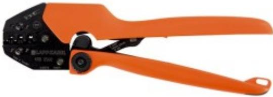
KRB 0560: Crimpzange zum Verpressen von unisolierten Flachsteckhülsen 4,8 und 6,3 von 0,5-6mm<sup>2</sup>,
