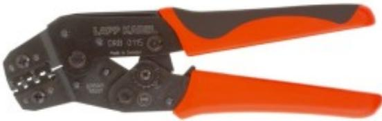
DRB 0505/DRB 0115: Crimpzange zum Verpressen von unisolierten Flachsteckhülsen 2,8 von 0,05-1,5mm<sup>2</sup>, Crimpprofil: Rolpressung, hohe Ergonomie des Werkzeugs
