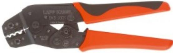
DKB 0325/DKB 0360: Crimpzange zum Verpressen von für unisolierte Kabelschuhe von 0,25-6,0 mm<sup>2</sup>, Crimpprofil: Dornpressung, hohe Ergonomie des Werkzeugs
