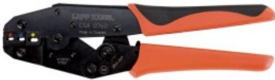
CSA/KSA 0760: Crimpzange zum Verpressen von isolierten Verbindern wie isolierte Kabelschuhe, Flachsteckverbinder von 0,5-6mm<sup>2</sup>, Crimpprofil: Oval, hohe Ergonomie des Werkzeugs
