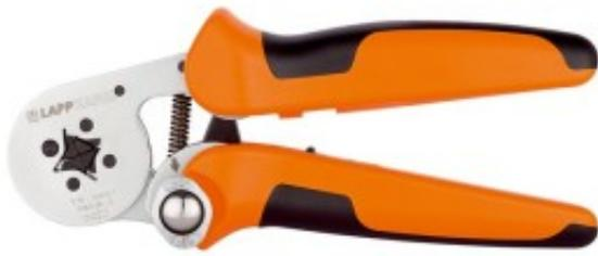
PEW 8.185 Crimpzange zum Verpressen von isolierten Aderendhülsen mit einer Vierkant-Pressung, in Deutschland hergestellt, schnell und zuverlässig
