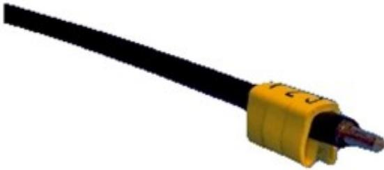
Geschlossene Bezeichnungsringe/Markierhülsen PC mit aufgedruckten Zahlen/Buchstaben zum Aufschieben auf die Einzeladern vor der Montage, flammwidrig nach UL 94 V0
