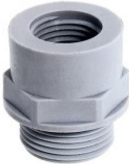
Ermöglicht den Einsatz von Kabelverschraubungen deren Anschlussgewinde größer sind als vorhandene Gewindebohrungen; Montage mit Gabelschlüssel; Auflagefläche für Gabelschlüssel, dadurch kein verkratzen des Gehäuses
