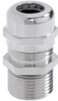
Für Kabel und Leitungen mit und ohne Innenmantel geeignet; Ebenfalls geeignet zur Weiterführung des Leitungsschirms zu einem anderen Anschluss; Niederohmiger Schirmkontakt, optimaler EMV-Schutz; hochleitfähige, flexible EMV-Kontaktfeder, dadurch einfache Installation verschiedener Schirmdurchmesser; Wenige Arbeitsschritte, einfache Montage
