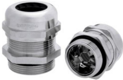
Für Kabel und Leitungen mit und ohne Innenmantel geeignet; Ebenfalls geeignet zur Weiterführung des Leitungsschirms zu einem anderen Anschluss; Niederohmiger Schirmkontakt, optimaler EMV-Schutz; hochleitfähige, flexible EMV-Kontaktfeder, dadurch einfache Installation verschiedener Schirmdurchmesser; Wenige Arbeitsschritte, einfache Montage
