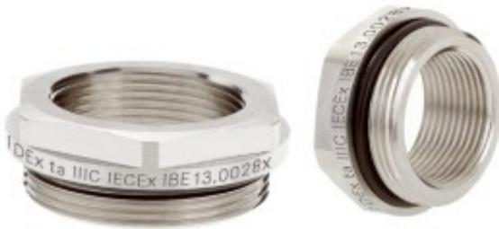
Ermöglicht den Einsatz von Kabelverschraubungen deren Anschlussgewinde kleiner sind als vorhandene Gewindebohrungen; Mit Führungsnut für O-Ring; Montage mit Gabelschlüssel
