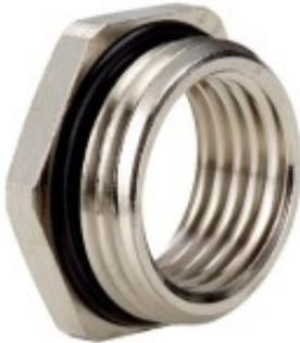
Ermöglicht den Einsatz von Kabelverschraubungen deren Anschlussgewinde kleiner sind als vorhandene Gewindebohrungen; Mit Führungsnut für O-Ring; Montage mit Gabelschlüssel
