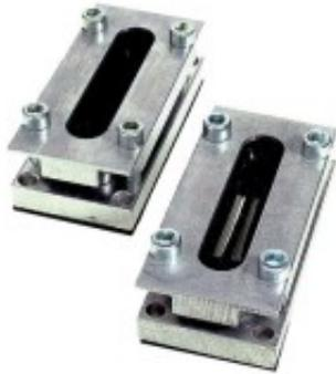
Dichtungsprofile lassen viele individuelle Problemlösungen zu; Es können mehrere Flach- und Rundkabel gleichzeitig eingeführt werden; Über die konische Innenkontur im Gehäuse-Oberteil werden die Dichteinsätze auf das Kabel gedrückt
