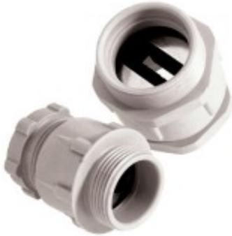
Wirtschaftliche Kunststoffausführung; seitliche Dichtlippen passen sich automatisch an; Kabelindividuelle Dichtungsabmessungen entfallen; maßtolerantes System; Große lichte Weite, somit können bis zu zwei Flachleitungen geklemmt werden
