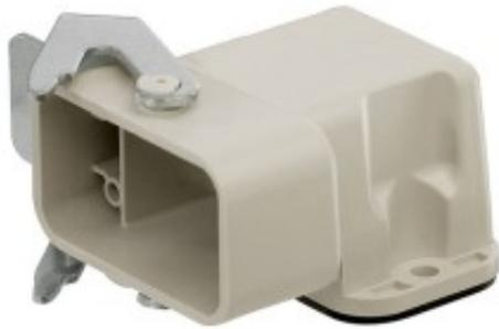
Das Gehäuse in Kunststoff oder Metallausführung. Zur Stromversorgung auf kleinstem Raum; Zwischenstutzen für Kabelverschraubung integriert, mit spezieller H-Q Verschraubung zu verwenden; bei Metallgehäusen ist EMV Verschraubung optional erhältlich
