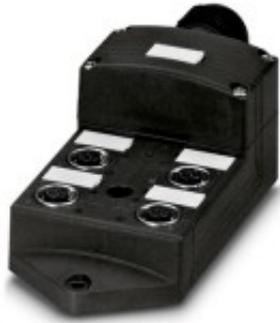
Passive Verteilerboxen mit M12-Steckplätzen und Stammkabelanschluss für individuelle Leitungslängen im vergossenen Gehäuse zur strukturierten Verdrahtung von Sensoren und Aktoren
