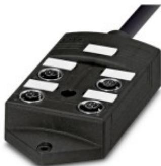
Passive Verteilerboxen mit M12-Steckplätzen und fest angeschlossenen Stammkabel im vergossenen Gehäuse zur strukturierten Verdrahtung von Sensoren und Aktoren
