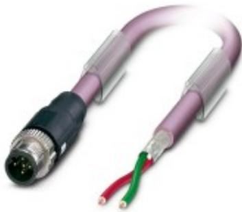
Robuste, vorkonfektionierte PROFIBUS Leitung M12 (B-kodiert) mit PUR (halogenfrei) Außenmantel für den flexiblen Einsatz (Schleppkette). Geschirmte Ausführung.
