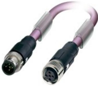
Robuste, anschlussfertige PROFIBUS Leitung M12 (B-kodiert) mit PUR (halogenfrei) Außenmantel für den flexiblen Einsatz (Schleppkette). Geschirmte Ausführung.
