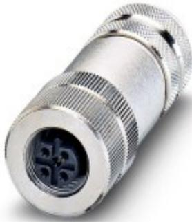
Feldkonfektionierbare M12 Feldbus-Steckverbinder für PROFIBUS, CANopen, DeviceNet, ETHERNET und PROFINET, geschirmte Ausführung, hohe Schutzklasse (IP67)
