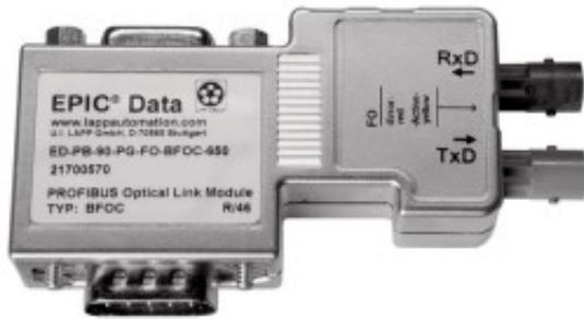
D-Sub Daten-Steckverbinder (9-pol.) für PROFIBUS DP nach IEC 61158, IEC 61784, mit optischem Interface und Repeaterfunktionalität, LWL Interface (POF und PCF)
